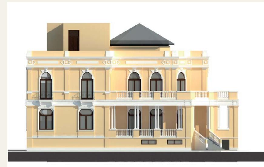
Vista del levantamiento en sistema BIM del inmueble.
