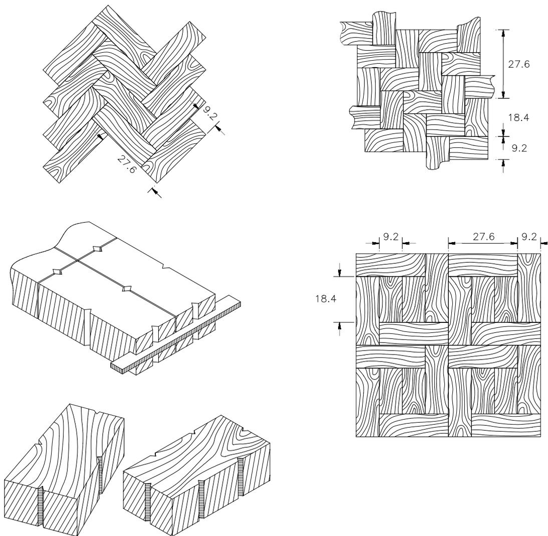
LOS ADOQUINES DE MADERA, ESTAN FABRICADOS DE ARBOLES DE FIBRAS COMPACTAS COMO EL PINO O EL ENCINO, ESTOS SON SOMETIDOS A UN PROCESO DE ESTUFADO Y DESFLEMADO, HASTA OBTENER LA MADERA CON EL CONTENIDO DE HUMEDAD ADECUADO.
