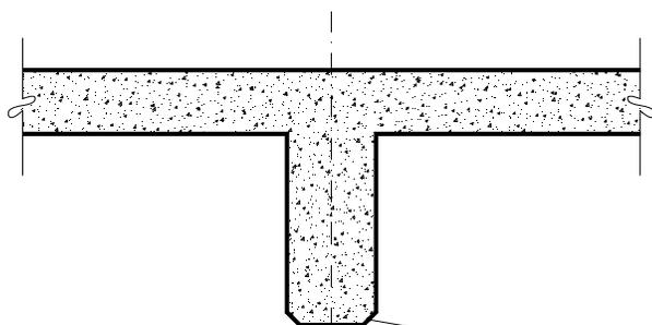
LA COLOCACION DE CHAFLAN SE HARA EN AQUELLOS ELEMENTOS DE CONCRETO QUE POR DISEÑO QUEDARAN EXPUESTOS Y CUYA ARISTA PUEDA DESMOLACHARSE AL DESCIMBRAR EN, AQUELLOS LUGARES DONDE SE VAYA A APLANAR CON MORTERO NO ES NECESARIO COLOCAR CHAFLANES.
