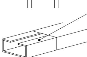
PARA BASTIDORES DE ALTURAS MAYORES DE 3.0m. UNIR UN POSTE CON OTRO, ENCONTRADOS, DEJANDO UN TRASLAPE DE 20cm. MINIMO Y UNIRLOS CON REMACHES "POP" O CON AMARRE DOBLE DE ALAMBRE GALVANIZADO DEL No.18
